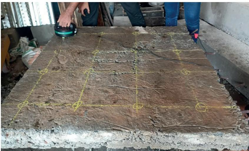
Rys. 2. Siatka do pomiarów szybkości korozji i rezystywności, na próbkach płytowych, za pomocą techniki iCOR®.
