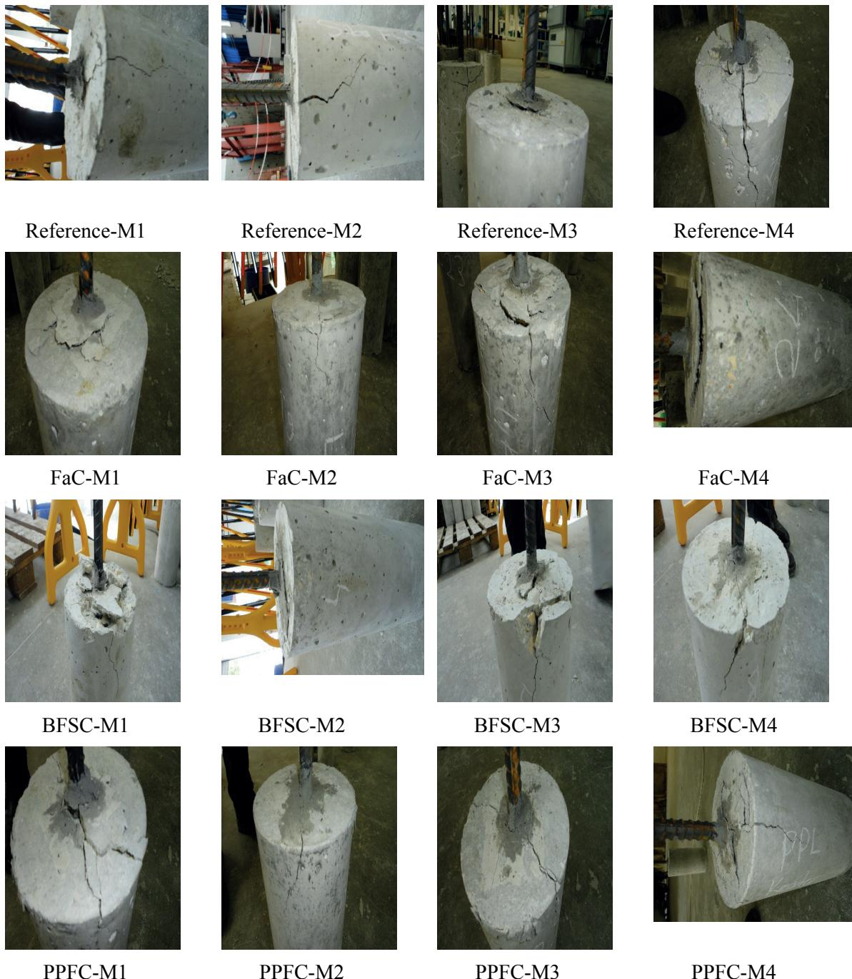
Rys. 5. Zdjęcia rodzaju zniszczenia elementów badanych
