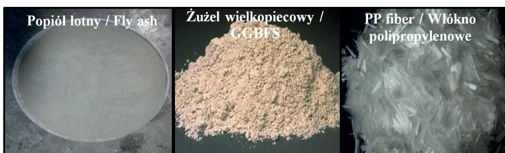
Rys. 1. Dodatki stosowane w mieszankach betonowych
