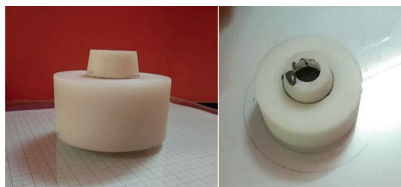
Rys. 1. Zestaw do pomiaru konsystencji zaczynów
