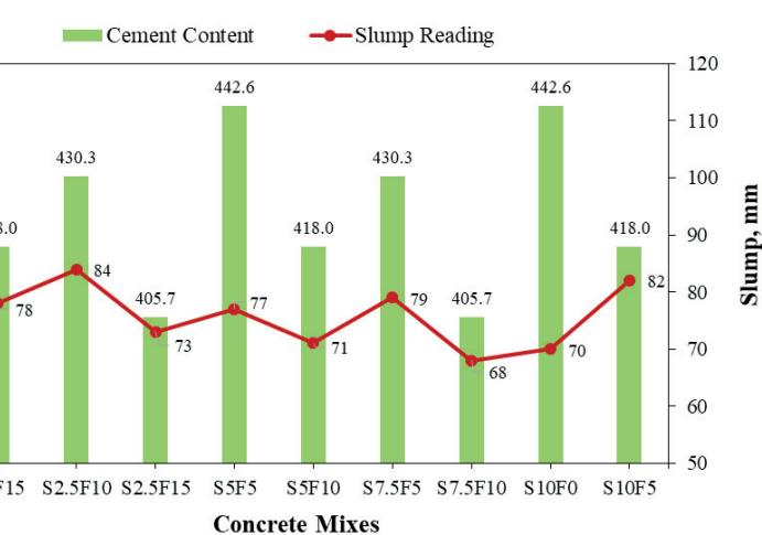
Rys. 6. Zawartość cementu i opad stożka w mieszaninach betonowych
