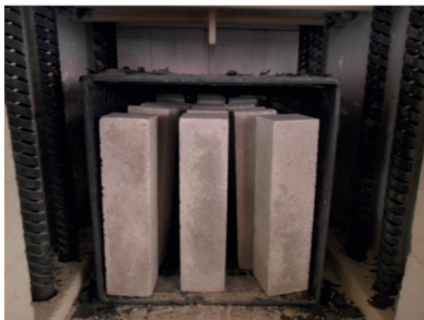
Rys. 1. Wygrzewanie próbek zaprawy cementowej w piecu wysokotemperaturowym
