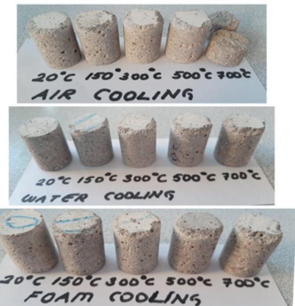
Rys. 8. Chłodzone rdzenie z zaprawy z cementu portlandzkiego
