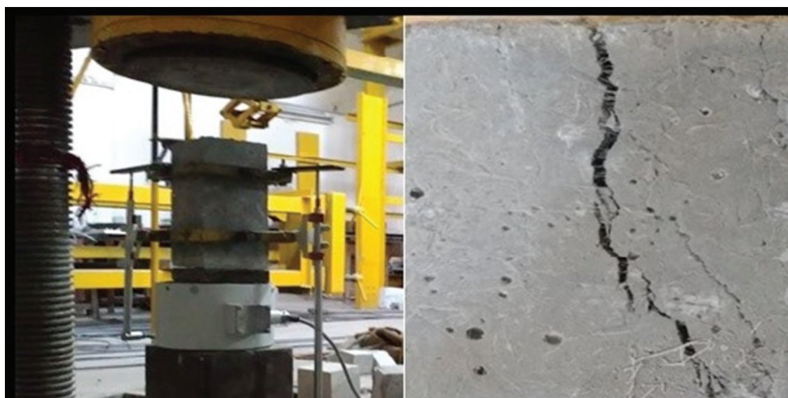
Rys. 1. Badanie zależności naprężenie-odkształcenie oraz zniszczona próbka
