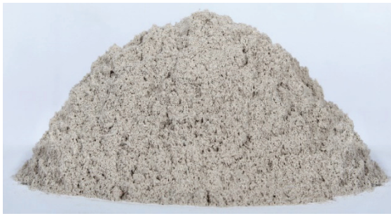
Rys. 3. Popiół ze słomy ryżowej prażonej przez 90 minut w 500°C
