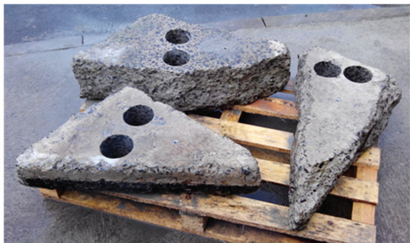
Rys. 2. Przykładowe fragmenty nawierzchni, z których pobierano próbki do badań
