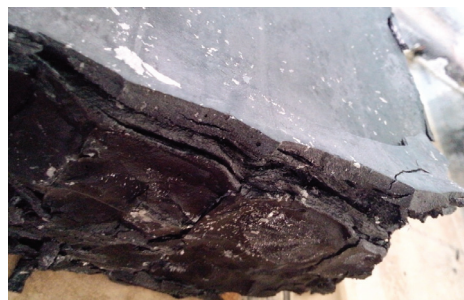
Rys. 1. Próbkę zaczynu żuźlowego po 19 dniach korozji w roztworze (\text{NH}_4)_2\text{SO}_4
