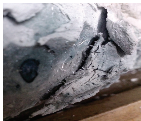
Rys. 2. Kryształy gipsu na powierzchni próbki i pomiędzy odszczepionymi warstwami
