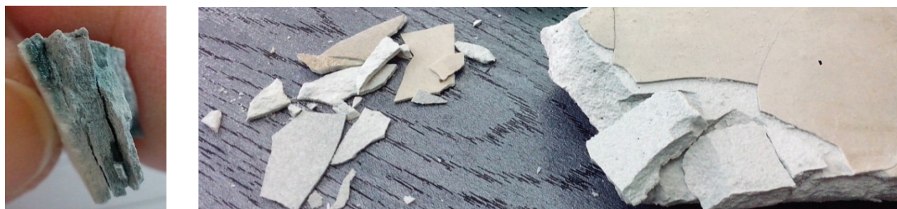
Rys. 5. Warstwy skorodowanego zaczynu żuźlowego
