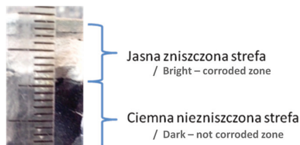
Rys. 9. Przełam zaczynu z żużla poddanego korozji z przyłożoną podziałką milimetrową i widoczną granicą między strefą zniszczoną i nienaruszoną
