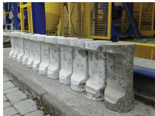
Rys. 2. Miejsca pobierania próbek wycinkowych z fragmentu płyty PK500
