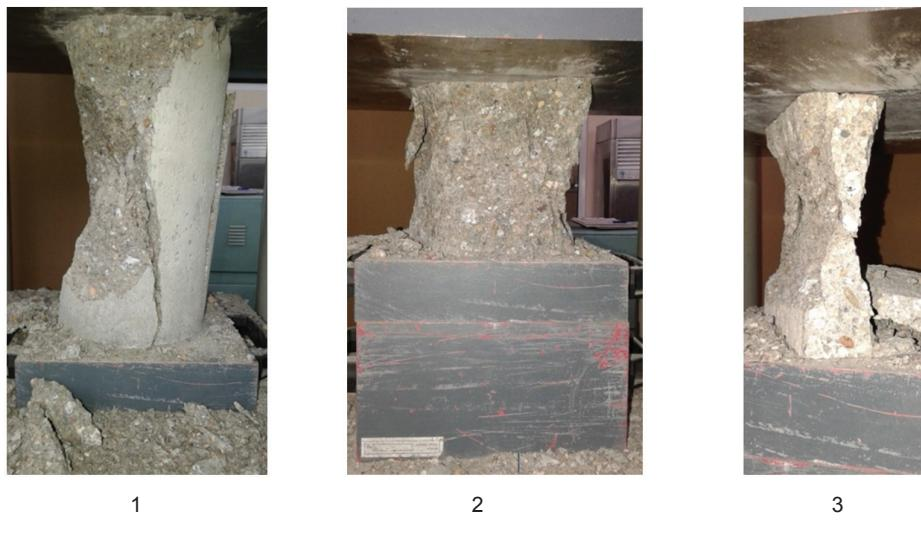
Rys. 3. Formy zniszczenia próbek w badaniu osiowego ściskania na próbkach walcowych (1), kostkowych (2) oraz wycinkowych (3)
