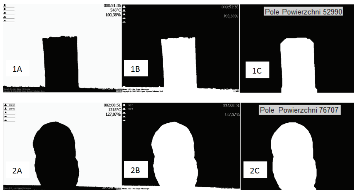
Rys. 3. Pojedyncze klatki obrazu wykorzystywane podczas pomiaru pola powierzchni: próbki wyjściowej (symbole 1) i próbki wykazującej przyrost objętości (symbole 2), analizowanych w mikroskopie wysokotemperaturowym HSM przy użyciu programu Matlab: A – obrazy rzeczywiste klatek filmu, B – obrazy odwróconych kolorów po binaryzacji, C – wynik zliczania powierzchni największej figury geometrycznej obrazu
