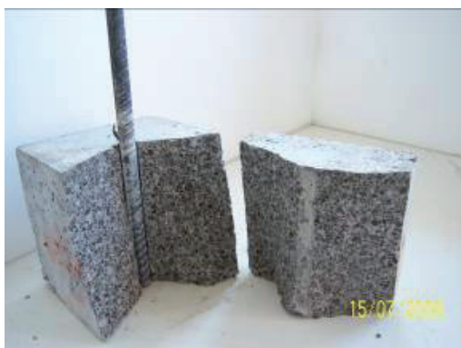
Rys. 13. Próbkki betonu poddane badaniu metodą „pullout”
