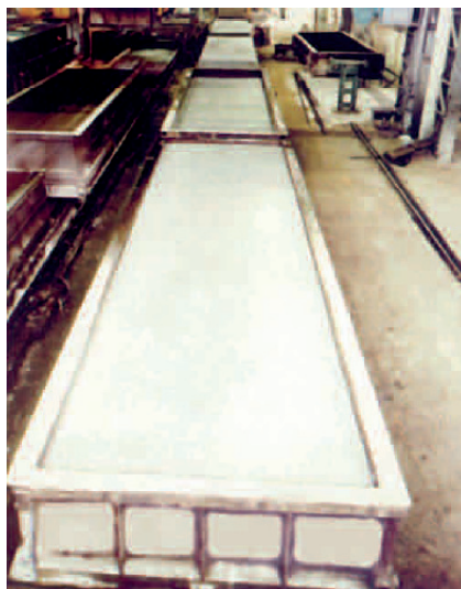
Rys. 1. Dojrzewające odlewy ABK w hali produkcyjnej
