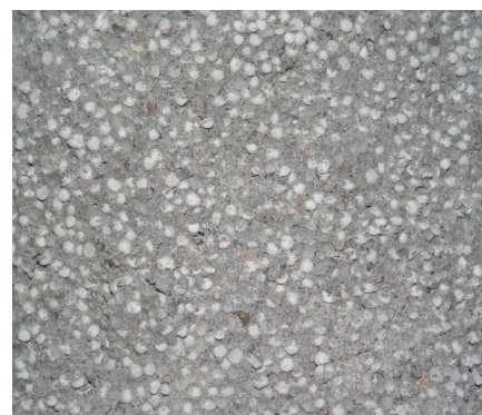
Rys. 1. Przełam próbki styrobetonowej
