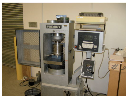
Rys. 1. Widok urządzenia do wyciskania fazy ciekłej umieszczonego w prasie hydraulicznej
