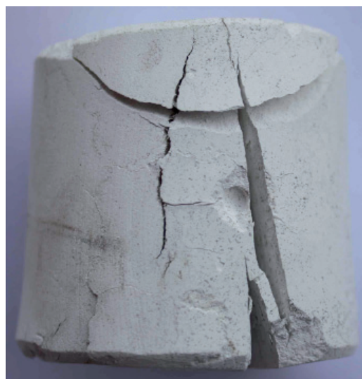
Rys. 2. Cylindryczna próbka wapienia karbońskiego ze złoża w Czatkowicach po dekarbonatyzacji: górna podstawa próbki bez głębokich spękań, na której dokonano pomiarów średnicy przed i po dekarbonatyzacji (Charakterystyka próbki: masa początkowa próbki m_0 = 191,28 \pm 0,01 g, przedział ufności dla średnicy d = 45,138 \pm 0,06 mm, przedział ufności dla wysokości h = 45,250 \pm 0,10 mm, masa końcowa próbki m_k = 107,79 \pm 0,01 g, skurcz obliczony dla górnej podstawy wynosi około 2%).
