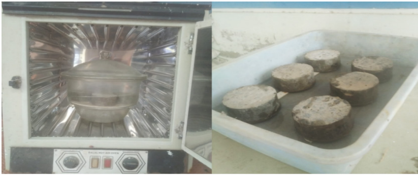
Rys. 1. Przygotowanie próbek i badanie sorpcyjności
