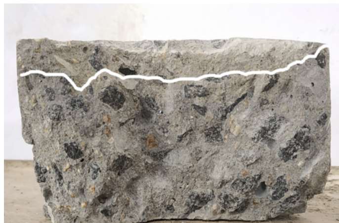
Rys. 4. Fragment próbki poddanej ocenie głębokości penetracji jonów chlorkowych,
