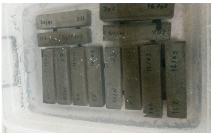
Rys. 4. Próbki w roztworze korozyjnym
