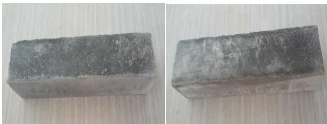
Rys. 6. Wygląd próbek po 336 dniach zanurzenia w roztworze Na_2SO_4
