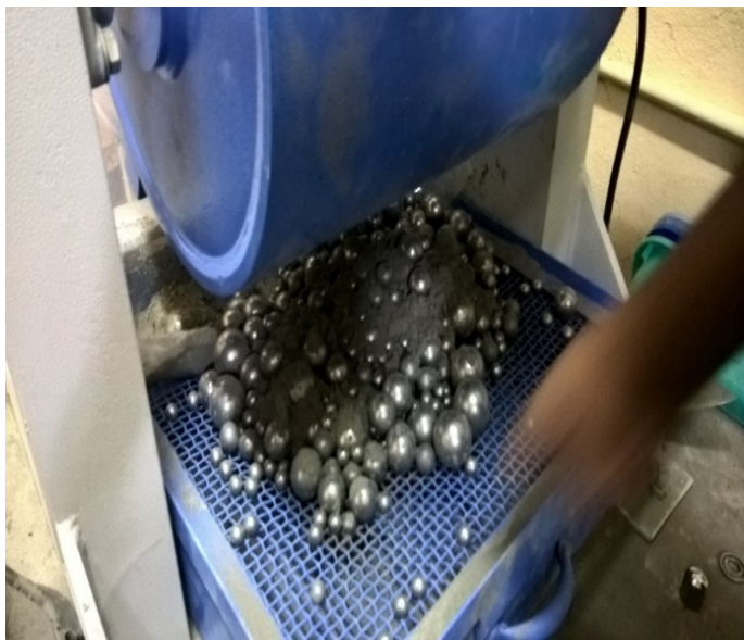
Rys. 1. Produkcja cementu mieszanego w młynie kulowym
