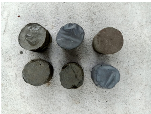
Rys. 4. Przygotowanie próbek do badań mikrostruktury
