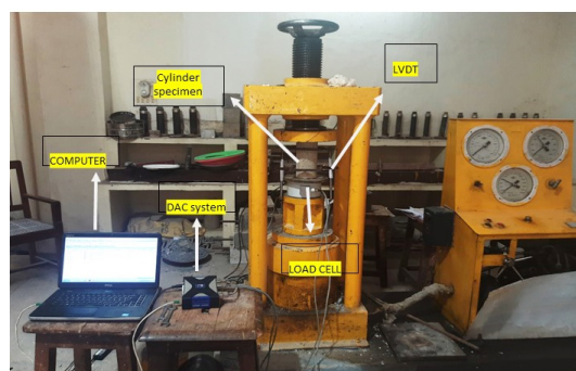
Rys. 2. Stanowisko do badań zależności naprężenie - odkształcenie betonu.
