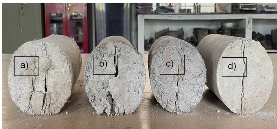
Rys. 3. [a–d]. Cylindry z różną zawartością włókien po zniszczeniu.
