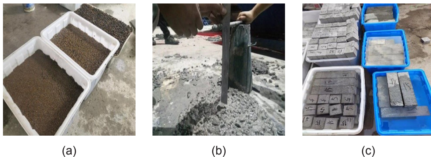
Rys. 3. Proces przygotowania próbek: a) wstępne nawilżanie popiołoporytu; b) pomiar opadu stożka; c) pielęgnacja próbek.
