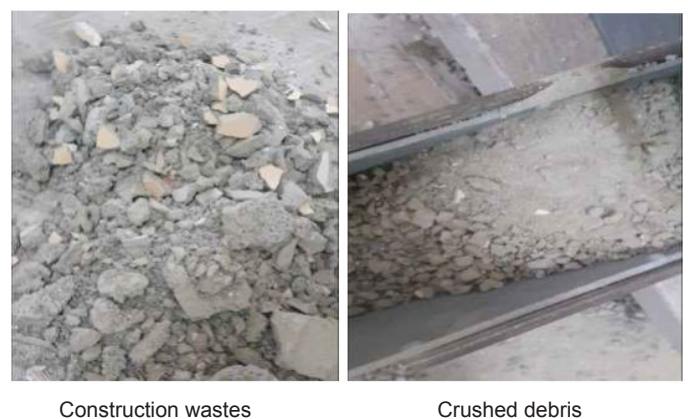
Rys. 2. Odpady budowlane użyte do przygotowania FRCA. Fig. 2. Construction wastes to produce FRCA.
