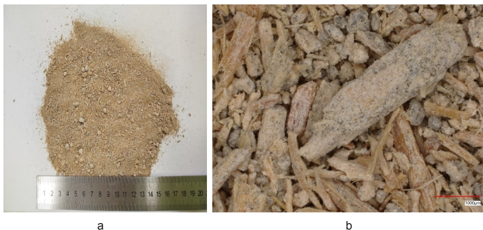
Rys. 1. Drobnziarnisty materiał odpadowy pochodzący z produkcji płyt CETRIS: a) widok ogólny materiału, b) obraz uzyskany metodą mikroskopii optycznej (25). Długość wskaźnika skali na zdjęciu b wynosi 1000 \mu\text{m} .
