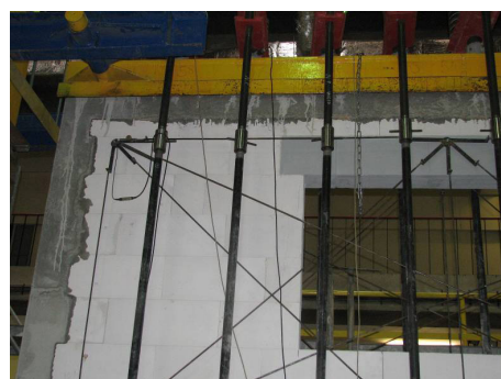
Rys. 11. Zarysowania ścian skrupowanych serii HAS-C1-AAC: a), b) modele wstępnie ściskane do wartości \sigma_c = 0,1 \text{ N/mm}^2 , c), d) modele wstępnie ściskane do wartości \sigma_c = 0,75 \text{ N/mm}^2 , e), f) modele wstępnie ściskane do wartości \sigma_c = 1,0 \text{ N/mm}^2
