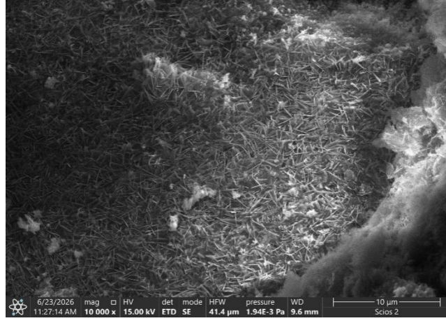
Rys. 4. Mikrostruktura autoklawizowanego betonu komórkowego wykonanego z cementu portlandzkiego żuźłowego CEM II/A-V 52,5 R.
