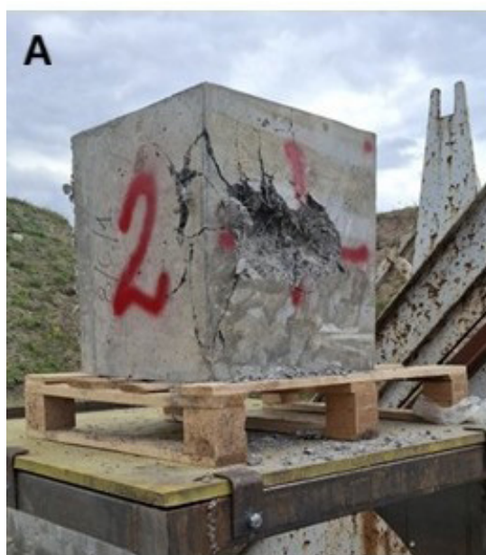
Rys. 6. Widok elementu prefabrykowanego po ostrzale czterema pociskami amunicji 12,7×108 B32; widok od strony ostrzału (A) i od strony tylnej (B).
