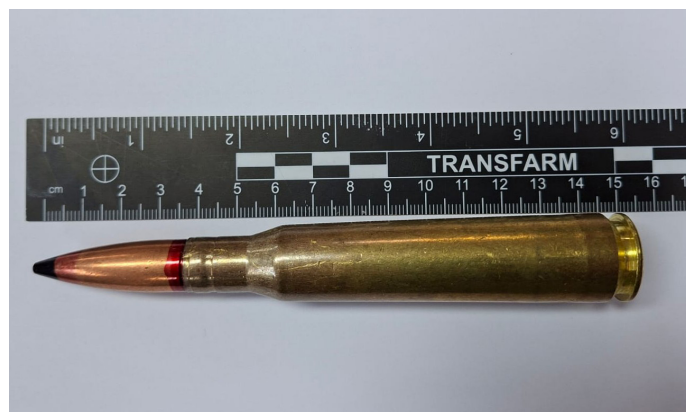
Rys. 3. Widok zastosowanej amunicji – amunicja kalibru 12,7 × 108 mm typu B32.
