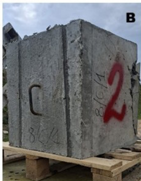
Rys. 6. Widok elementu prefabrykowanego po ostrzale czterema pociskami amunicji 12,7×108 B32; widok od strony ostrzału (A) i od strony tylnej (B).
