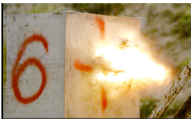
Rys. 5. Element prefabrykowany w trakcie ostrzału i po ostrzale.
