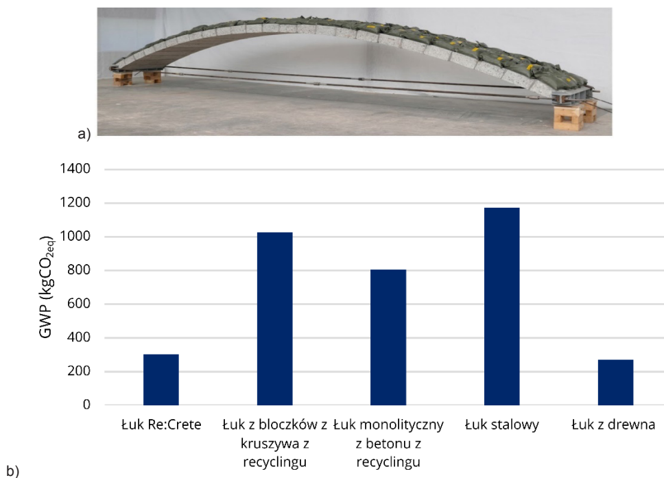
Rys. 4. Projekt Re:Crete: a) widok łuku z obciążeniem próbnym, b) porównanie GWP dla kładki z bloczków z odzysku i rozwiązań alternatywnych (8).
