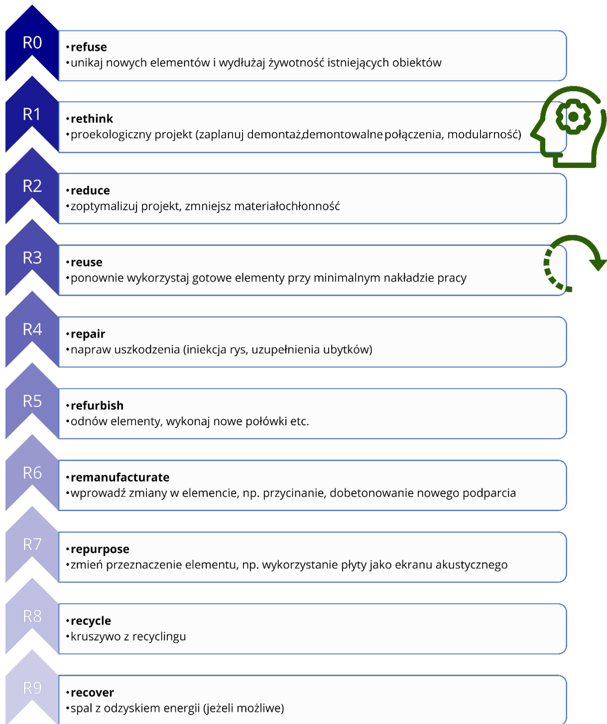
Rys. 2. Strategia 10-R budownictwa cykularnego opartego na prefabrykatach z betonu (7).
