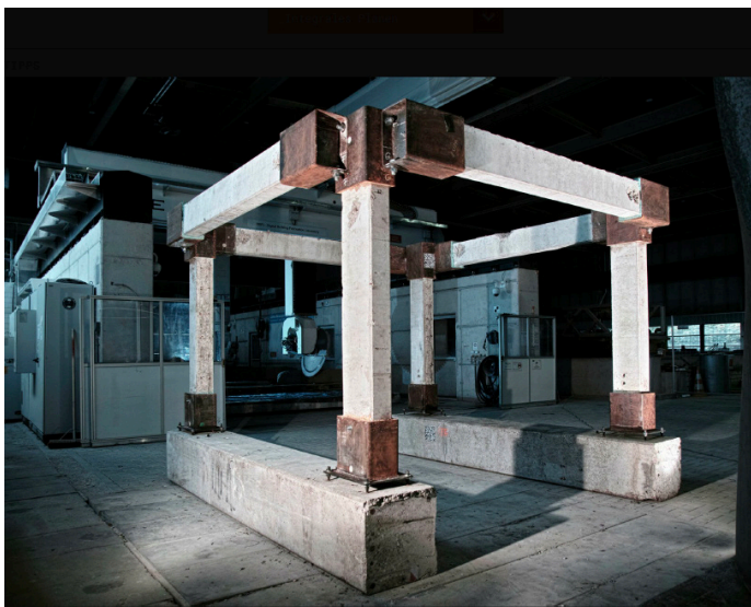
Rys. 5. Demonstrator pokazujący połączone prefabrykaty z odzysku (16).
